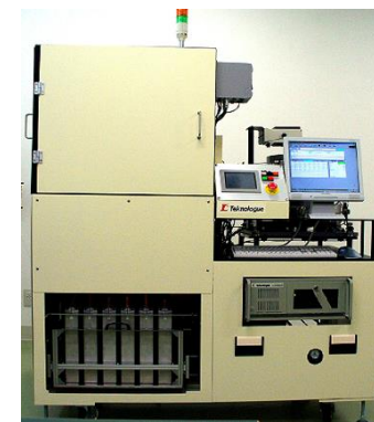
LAMP型LED全自動選別機
