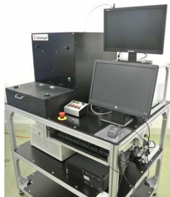
LED点灯画像、電気及び 光学特性半自動測定機
