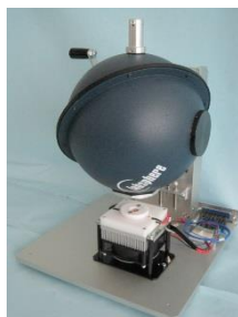
SMD型LED用 積分球測定治具
